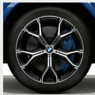
□ Llantas de aleación ligera M de 21 pulgadas con radios en Y estilo 741 M, en bicolor Orbitgrau, con neumáticos de distintas medidas, pulido brillante, delante 9,5 J x 21, neumáticos 275/40 R 21, detrás 10,5 J x 21, neumáticos 315/35 R 21.<sup>2,3</sup>
