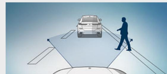
■ **Active Guard**\* incluye el aviso de colisión frontal con función de frenado y el aviso de salida de trayecto.
