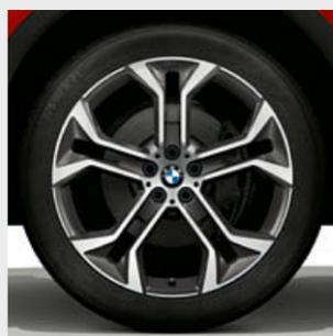
□ Llantas de aleación ligera de 21 pulgadas con radios en Y estilo 744, en bicolor Orbitgrau, con neumáticos de distintas medidas y funcionamiento en caso de avería, pulido brillante, delante 9,5 J x 21, neumáticos 275/40 R 21, detrás 10,5 J x 21, neumáticos 315/35 R 21.<sup>1</sup>
