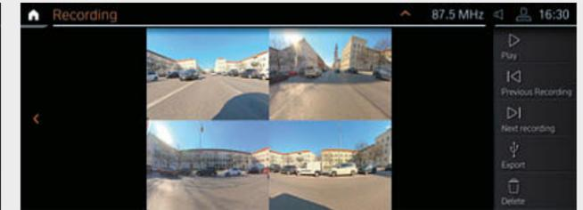
□ BMW Drive Recorder\* permite grabar un video del entorno del vehículo y reproducirlo en el display de control central o exportarlo a través de USB a su dispositivo de reproducción. Datos importantes del vehículo, como la velocidad y la posición GPS, se almacenan de manera sincronizada con el video. Drive Recorder cuenta con dos subfunciones: Eventrecorder y Crashrecorder.
