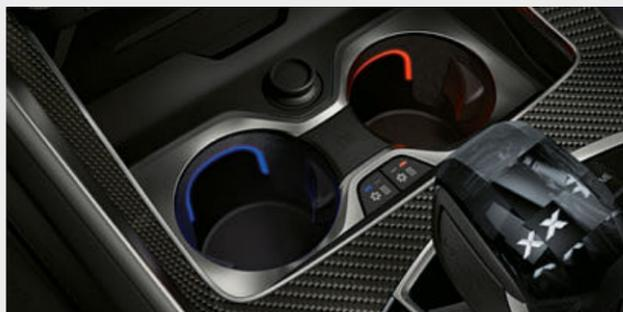
□ Los portabebidas de la consola central pueden enfriar por separado las bebidas que sujetan o mantenerlas calientes. La climatización se activa mediante botones situados a derecha e izquierda. La luz ambiente indica además la función (azul para enfriar o rojo para calentar).
