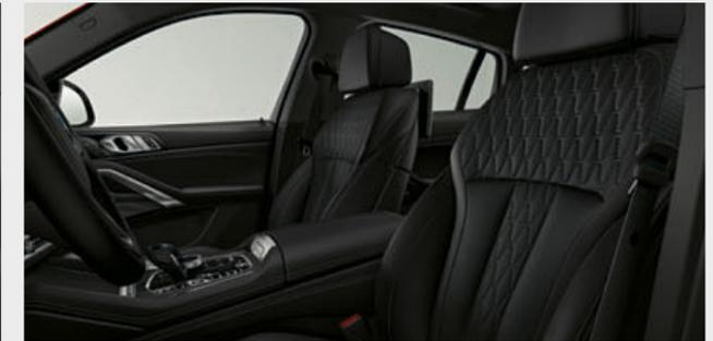
□ Los asientos de confort para conductor y acompañante, con reposacabezas activos, se pueden regular eléctricamente de muchas maneras. Se adaptan por separado el segmento superior y la anchura del respaldo, los apoyos para las piernas y la altura del reposacabezas. El equipamiento incluye además soporte lumbar y función de memoria para el conductor y el acompañante.
