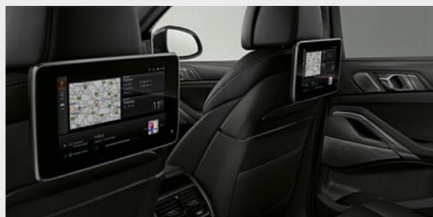
□ El equipamiento del sistema de entretenimiento en la parte trasera Professional incluye dos pantallas en color de alta resolución e independientes de 26,04 cm (10,2 pulgadas) con inclinación regulable, funcionamiento táctil y una unidad de Blu-ray. Esto permite la navegación y el uso de Internet en marcha (con un contrato de telefonía móvil). Además, se ofrecen una conexión USB y conexiones para reproductor MP3, consolas de videojuegos y auriculares (también inalámbricos).
