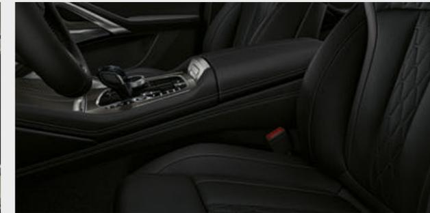
□ La ventilación activa de los asientos delanteros\* proporciona una temperatura fresca y agradable con temperaturas exteriores elevadas y, con ello, una mayor comodidad. Los ventiladores integrados en los asientos, incluido el respaldo, aspiran el aire según la intensidad elegida. Las superficies perforadas llevan acabado en cuero Vernasca.
