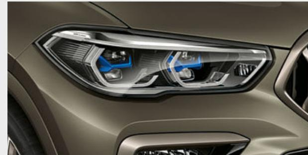
□ La Luz láser BMW con diseño X independiente alumbrando en el modo de luz de carretera láser hasta 500 m, prácticamente el doble que los faros convencionales. Gracias a la mejor visibilidad en la oscuridad, se incrementa considerablemente la seguridad. El distintivo "X" en azul y el anagrama "BMW Laser" subrayan la aspiración tecnológica del vehículo.
