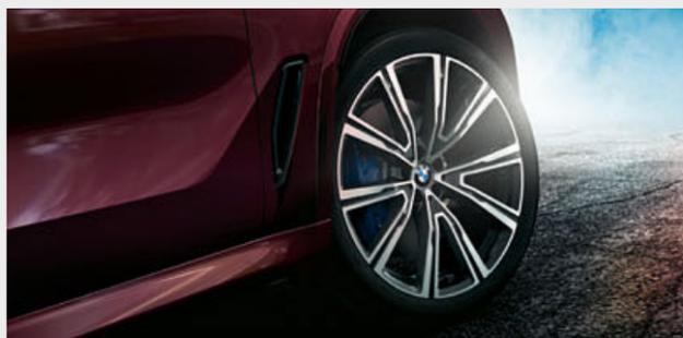
□ Llantas de aleación ligera BMW Individual de 22 pulgadas con radios en V estilo 746 I, Orbitgrau, con pulido brillante, neumáticos de distintas medidas, delante 9,5 J x 22, neumáticos 275/35 R 22, detrás 10,5 J x 22, neumáticos 315/30 R 22.
