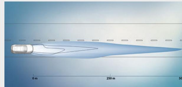
□ La Luz láser BMW con diseño X independiente ilumina en el modo de luz de carretera láser hasta 500 m, prácticamente el doble que los faros convencionales. Gracias a la mejor visibilidad en la oscuridad, se incrementa considerablemente la seguridad. El distintivo "X" en azul y el anagrama "BMW Laser" subrayan la aspiración tecnológica del vehículo.
