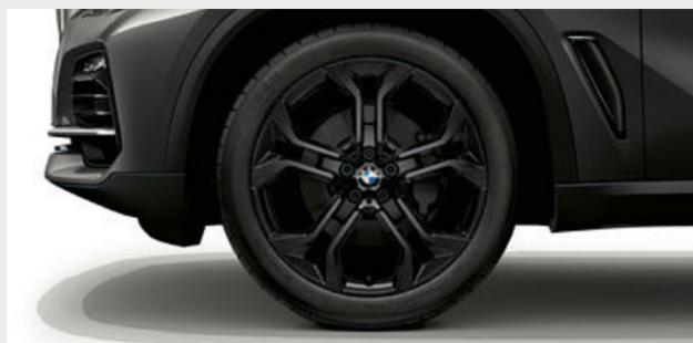
□ Llantas de aleación ligera de 21 pulgadas con radios en Y estilo 744, en Orbitgrau, con neumáticos de distintas medidas y funcionamiento en caso de avería, delante 9,5 J x 21, neumáticos 275/40 R 21, detrás 10,5 J x 21, neumáticos 315/35 R 21.<sup>1</sup>
