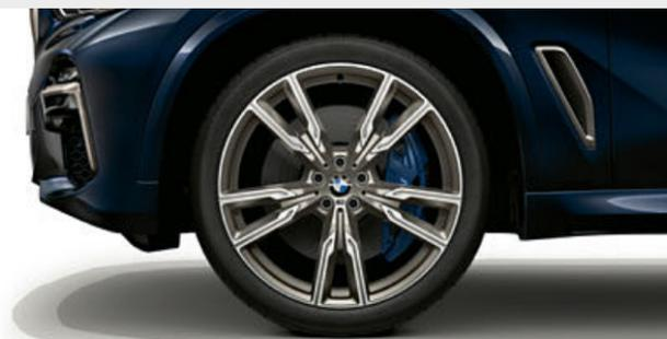
□ Llantas de aleación ligera M de 22 pulgadas con radios en V estilo 747 M, en Ceriumgrau mate, con pulido brillante, neumáticos de distintas medidas, delante 9,5 J x 22, neumáticos 275/35 R 22, detrás 10,5 J x 22, neumáticos 315/30 R 22.<sup>3</sup>
