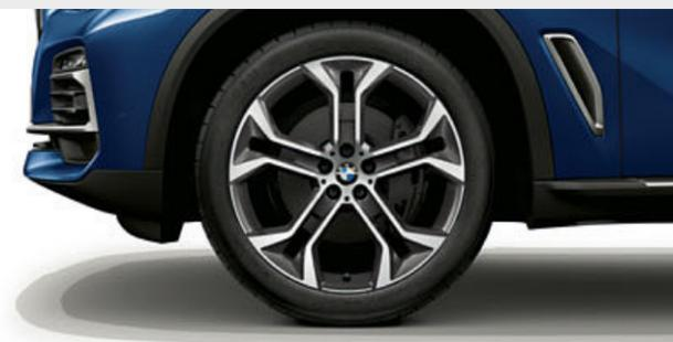
□ Llantas de aleación ligera de 21 pulgadas con radios en Y estilo 744, en bicolor Orbitgrau, con pulido brillante, neumáticos de distintas medidas y funcionamiento en caso de avería, delante 9,5 J x 21, neumáticos 275/40 R 21, detrás 10,5 J x 21, neumáticos 315/35 R 21.<sup>1</sup>
