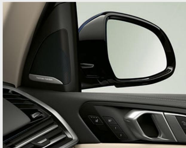
□ El extraordinario sistema de sonido envolvente Harman/Kardon ofrece un amplificador digital de 464 vatios, 9 canales y 16 altavoces. Proporciona un sonido armonioso y envolvente. Un sistema de ecualización totalmente automático, en función de la velocidad, compensa los ruidos propios de la conducción.
