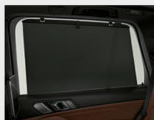
□ La persiana solar para las ventanillas traseras, que se controla manualmente, protege de la radiación solar y de las miradas indiscretas.
