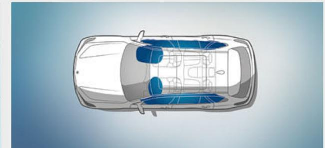
■ Los airbags para conductor y acompañante forman parte de los componentes de seguridad óptimamente coordinados entre sí de un BMW. Un total de seis airbags ofrecen protección selectiva: airbags para el conductor y el acompañante, airbags de cabeza para toda la superficie de las ventanillas laterales y airbags laterales en los respaldos de los asientos delanteros.
