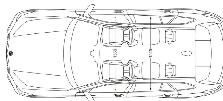
Todas las medidas de los dibujos técnicos se dan en milímetros. Altura sin antena: 1.466 mm. Anchura de vía del BMW X5 M50d - delante: 1.684 mm; detrás: 1.689.
