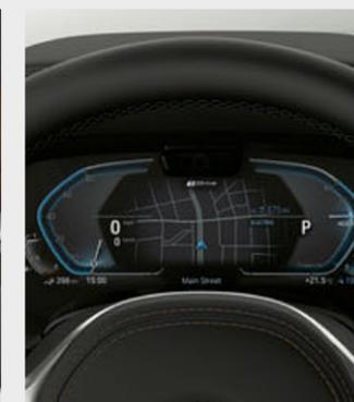
■ El cuadro de instrumentos específico para híbridos enchufables informa, por ejemplo, de la disponibilidad del vehículo para circular en modo eléctrico, el nivel de carga de la batería y el consumo promedio eléctrico.
