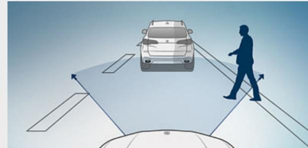
■ Active Guard Plus\* incluye el aviso de colisión frontal con función de frenado, el aviso de salida de trayecto con retorno activo al carril y el sistema Speed Limit Info, con incorporación manual de la velocidad de referencia para el limitador de velocidad. La función de frenado de emergencia reacciona en caso de riesgo de colisión con vehículos, peatones o ciclistas.
