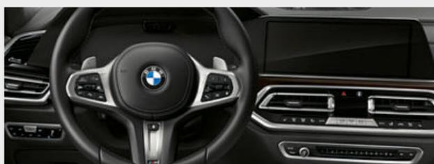
□ El volante M de cuero con multifunción<sup>2</sup>\*, emblema "M" y airbag integrado para el conductor presenta un diseño de 3 radios. Con un aro en cuero Walknappa Schwarz con costura negra y marcado apoyo para los pulgares, transmite una sensación deportiva y directa.
