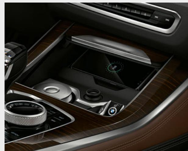
□ La telefonía con carga inalámbrica<sup>1</sup> incluye un cargador sin cable y un segundo micrófono aumenta la calidad del sistema manos libres del conductor y el acompañante. Una conexión a la antena de techo garantiza una recepción óptima de la señal de telefonía móvil. Por Bluetooth, es posible conectar dos teléfonos móviles y un reproductor de audio al mismo tiempo. A esto hay que añadir la preparación para Punto de Acceso WiFi.
