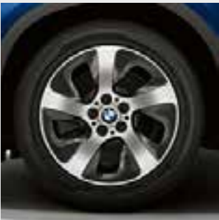
□ Llantas de aleación ligera de 17 pulgadas con diseño de turbina estilo 561, BMW EfficientDynamics, Orbitgrau y con pulido brillante, 7,5 J x 17, neumáticos 225/55 R 17.
