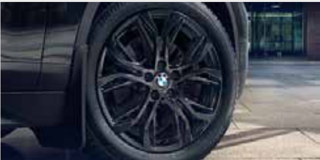
○ Las exclusivas llantas de aleación ligera de 18 pulgadas con radios en Y estilo 566 llevan acabado Schwarz y confieren al vehículo una nota especialmente deportiva. Juego de ruedas completas de verano RDC con neumáticos Run-Flat, 7,5 J x 18, neumáticos 225/50 R 18 95W RSC.
