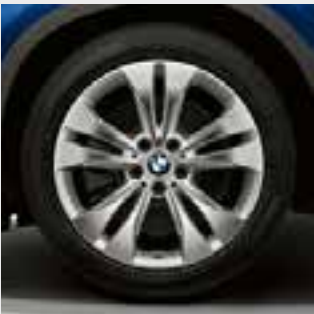
□ Llantas de aleación ligera de 18 pulgadas con radios dobles estilo 567, Reflexsilber, 7,5 J x 18, neumáticos 225/50 R 18.
