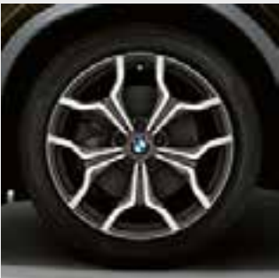
■ Llantas de aleación ligera M de 19 pulgadas con radios en Y estilo 2 722 M, Orbitgrau, pulido brillante, neumáticos con funcionamiento en caso de avería, 8J x 19, neumáticos 225/45 R 19.
