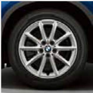
■ Llantas de aleación ligera de 17 pulgadas con radios en V estilo 560, Reflexsilber, 7,5 J x 17, neumáticos 225/55 R 17.
