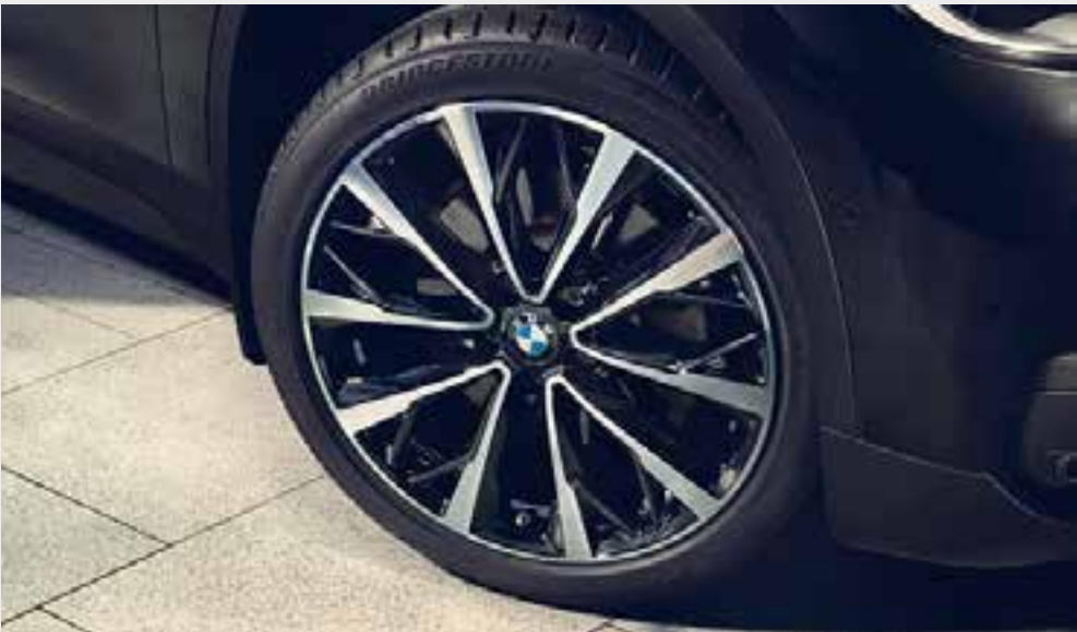
○ Las exclusivas llantas de aleación ligera de 19 pulgadas con radios en V estilo 573, en Bicolor Schwarz, presentan pulido brillante en la cara visible y están optimizadas en cuanto al peso. Juego de ruedas completas de verano con neumáticos Run-Flat, 8 J x 19, neumáticos 225/45 R 19 92W RSC.
