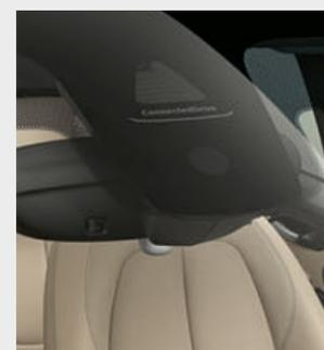
■ El sensor de lluvia con dispositivo de alumbrado automático activa, cuando es necesario, el limpiaparabrisas y la luz de cruce.
