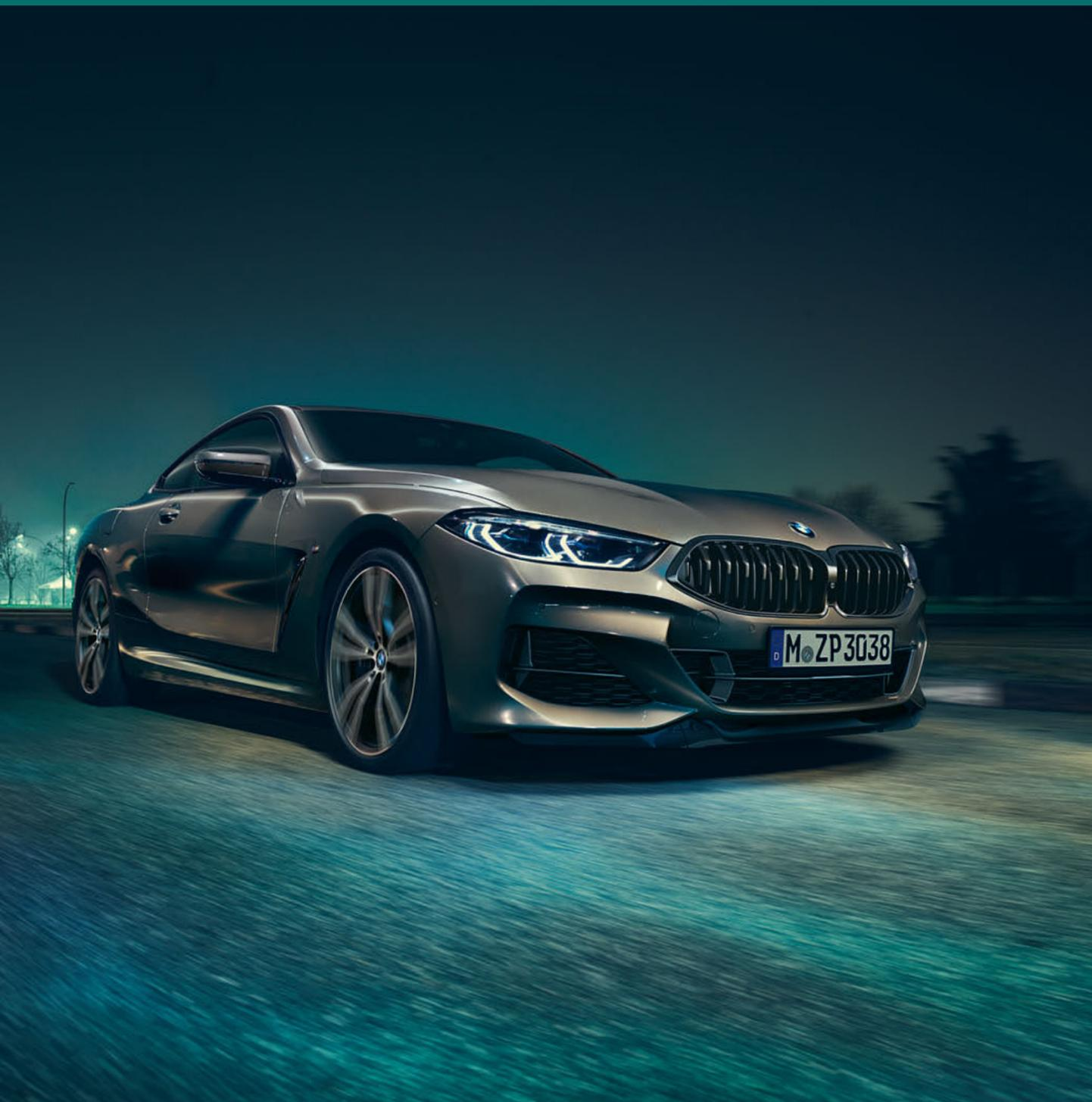
En la pintura especial Pure Metal Silber, los contrastes clarososcuros crean la impresión de metal fluido. Para ello, se aplica una capa de base con finas nanopartículas de aluminio, que se lija y se pule con la máxima precisión artesanal, así como una segunda capa de pintura con el acabado. El resultado: una pintura de luminoso color y brillo intenso, que atrae toda la atención.
