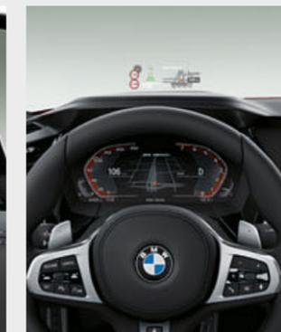
□ El BMW Head-Up Display<sup>3</sup> a todo color proyecta la información relevante para la conducción en el campo visual del conductor.
