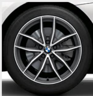
■ Llantas de aleación ligera de 18 pulgadas con radios en V estilo 770 en bicolor Orbitgrau, con neumáticos de distintas medidas, pulido brillante, delante 8 J x 18, neumáticos 225/45 ZR 18, detrás 9 J x 18, neumáticos 255/40 ZR 18.<sup>1,3</sup>
