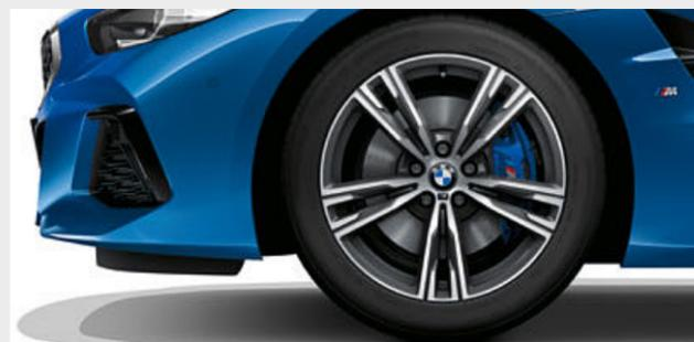
□ Llantas de aleación ligera M de 18 pulgadas con radios dobles estilo 798 M, en bicolor Orbitgrau, con neumáticos de distintas medidas, pulido brillante, delante 9 J x 18, neumáticos 255/40 ZR 18, detrás 10 J x 18, neumáticos 275/40 ZR 18.<sup>2,6</sup>
