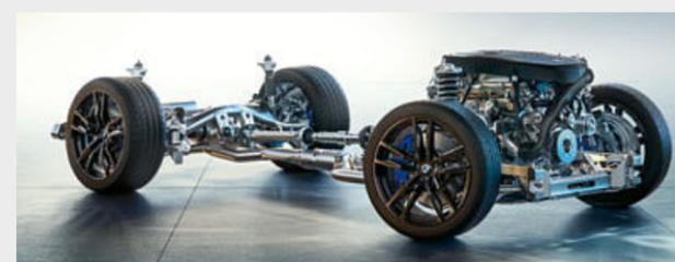
□ La suspensión M adaptativa<sup>1</sup> con reducción de la altura del chasis de unos diez milímetros se ajusta electrónicamente a las condiciones de la calzada y a la situación de conducción. Además, el conductor puede ajustar las características de la suspensión mediante el sistema Driving Experience Control al estilo de conducción que prefiera en un momento dado: desde cómodo hasta marcadamente deportivo con una conducción aún más ágil.
