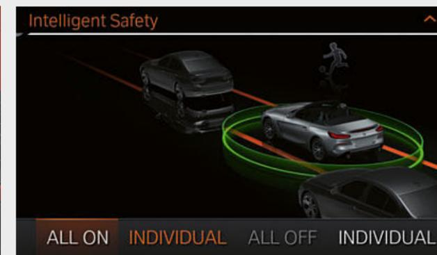
□ El paquete de seguridad Driving Assistant<sup>2</sup>\* ofrece los siguientes sistemas: aviso de colisión frontal con función de frenado, Speed Limit Assist, que incluye Speed Limit Info con indicación de prohibición de adelantar y previsión, y aviso de salida de trayecto. Además, los equipamientos basados en radar cuentan con aviso de tráfico trasero, advertencia de cambio de carril y aviso de colisión por alcance.
