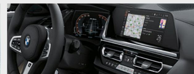
□ BMW Live Cockpit Professional con función de navegación incluye un exclusivo conjunto de indicadores que consta de un display de control de alta resolución de 26,04 cm (10,25 pulgadas) con función táctil y un cuadro de instrumentos totalmente digital del mismo tamaño.\*
