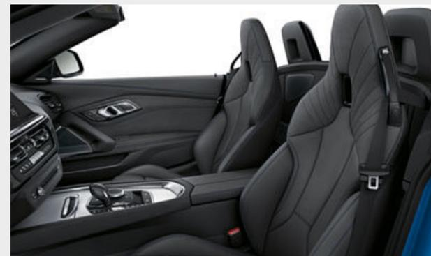
□ Los asientos deportivos M<sup>1</sup>\* con reposacabezas integrados, superficie profunda, rebordes elevados y parte superior de los laterales prominente ofrecen una mejor sujeción lateral al conductor y al acompañante.
