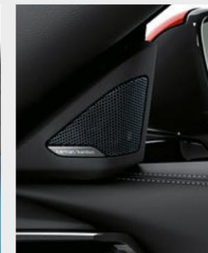
□ Sistema de sonido envolvente Harman/Kardon\* con amplificador digital de 408 vatios, 7 canales, ecualización específica del vehículo y 12 altavoces.
