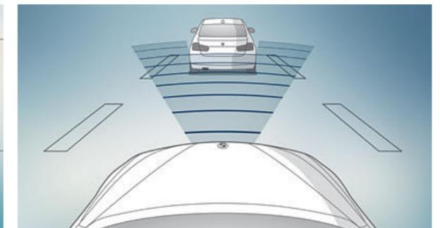
**Control de crucero activo. Con función Stop&Go<sup>2</sup>,** mantiene la velocidad programada y la distancia con el vehículo que circula delante.
