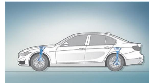
**Suspensión M adaptativa<sup>1</sup>.** Rebajada y con ajuste variable de la amortiguación, que permite elegir entre una configuración más cómoda o más deportiva. La seguridad aumenta así con la adaptación permanente del vehículo a cada situación de conducción.
