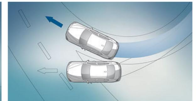
**Control Dinámico de Estabilidad (DSC).** Detecta la tendencia al derrapaje y estabiliza el vehículo.
