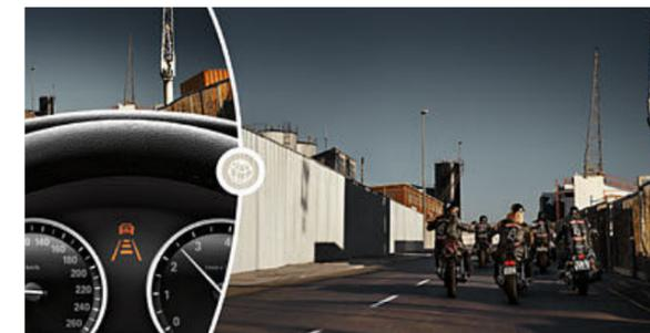
El sistema **Driving Assistant** (opcional)<sup>3</sup> combina el aviso de salida de trayecto y el aviso de colisión. Los avisos de colisión y de peatones con función de freno en ciudad advierten, a velocidades de entre 10 y 60 km/h, de colisiones con vehículos o personas y frenan en caso de emergencia. A partir de unos 70 km/h, el aviso de salida de trayecto advierte del abandono involuntario del carril con una ligera vibración del volante.
