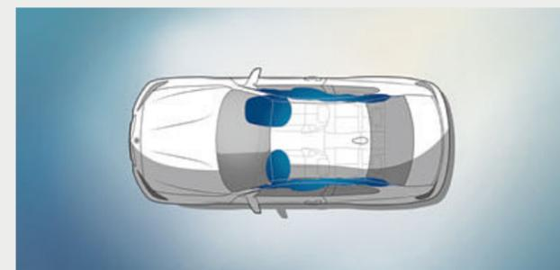
■ Los **airbags** para conductor y acompañante forman parte de los componentes de seguridad óptimamente coordinados entre sí de un BMW. Un total de seis airbags ofrecen protección selectiva: airbags para el conductor y el acompañante, airbags de cabeza para toda la superficie de las ventanillas laterales<sup>2</sup> y airbags laterales en los respaldos de los asientos delanteros.
