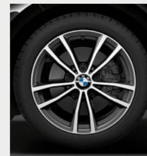
■ Llantas de aleación ligera de 17 pulgadas con radios dobles estilo 725, Orbitgrau pulido brillante, 7,5J x 17, neumáticos 225/45 R 17.
