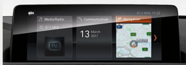
□ El sistema de navegación Professional, con conexión USB, pantalla LCD a color de 22,35 centímetros (8,8 pulgadas) y Radio BMW Professional con reproductor de DVD, cuenta con representación de mapas en 3D y memoria de 20 GB. El manejo se realiza de manera intuitiva con el controlador iDrive Touch o por pantalla táctil. Las actualizaciones de los mapas están disponibles con licencia gratuita durante tres años.<sup>2</sup>
