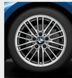
■ Llantas de aleación ligera M de 17 pulgadas de radios dobles estilo 460 M, con neumáticos de distintas medidas, delante 7,5J x 17, neumáticos 225/45 R 17, detrás 8J x 17, neumáticos 245/40 R 17.
