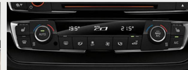
■ El climatizador bizona cuenta con control automático de la temperatura que el conductor y el acompañante pueden ajustar por separado. Incluye salidas en las plazas traseras, Control Automático de Recirculación de Aire, filtro activo, sensores solar y de empañamiento, y cambio automático de modo de día/noche en el display, pasando del blanco al naranja.
