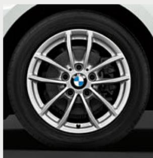
■ Llantas de aleación ligera de 16 pulgadas con radios en V estilo 378, 7J x 16, neumáticos 205/55 R 16.
