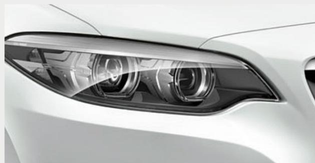
■ Desde la luz diurna hasta la luz de cruce y de carretera de los faros LED, todas las funciones incluyen tecnología LED, con una larga vida útil y un reducido consumo de energía. Los propios faros incluyen regulación automática del alcance de la iluminación y, con su excepcional luminosidad y una tonalidad similar a la luz diurna, incrementan la seguridad cuando se conduce de noche o con climatología adversa.
