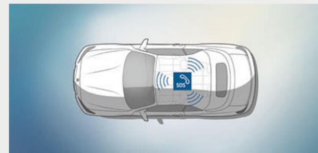
□ En caso necesario, la **Llamada de Emergencia Inteligente<sup>3</sup>** avisa automáticamente, a través del Centro de llamadas de BMW, al puesto de emergencia más próximo, sin tener que utilizar el teléfono móvil particular. Además de la posición del vehículo, se transmiten otros datos sobre la gravedad del accidente. La llamada de emergencia inteligente también puede iniciarse de forma manual, por ejemplo, para ayudar a otros conductores.
