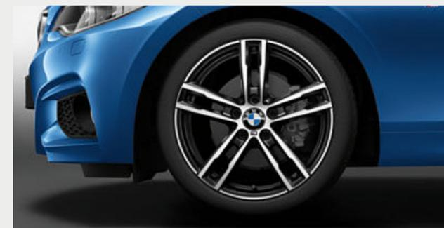
□ Llantas de aleación ligera M de 18 pulgadas con radios dobles estilo 719 M, en bicolor Jetblack, con neumáticos de distintas medidas, delante 7,5J x 18, neumáticos 225/40 R 18, detrás 8J x 18, neumáticos 245/35 R 18.
