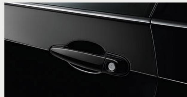
□ El acceso confort ofrece acceso al vehículo por las puertas delanteras y el portón trasero, sin necesidad de utilizar la llave del vehículo. Sin embargo, aún es necesario llevar encima la llave del vehículo, por ejemplo, en el bolsillo del pantalón. Después, para abrir el vehículo basta con tocar la manilla la puerta o el botón del portón trasero.
