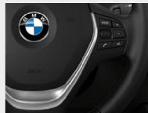
■ El volante multifunción permite controlar las funciones de teléfono, voz y audio, así como limitar manualmente la velocidad.
