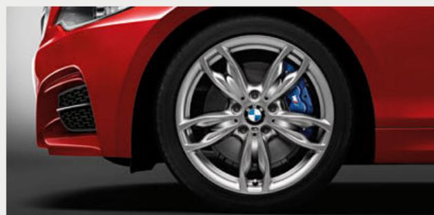
■ Llantas de aleación ligera M de 18 pulgadas de radios dobles estilo 436 M<sup>2</sup>, con neumáticos de distintas medidas, delante 7,5J x 18, neumáticos 225/40 R 18, detrás 8J x 18, neumáticos 245/35 R 18.
