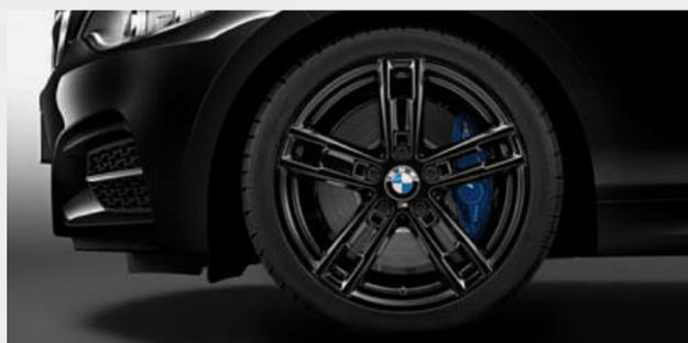
□ Llantas de aleación ligera M de 18 pulgadas con radios dobles estilo 719 M<sup>1</sup>, en Jetblack, con neumáticos de distintas medidas, delante 7,5J x 18, neumáticos 225/40 R 18, detrás 8J x 18, neumáticos 245/35 R 18.
