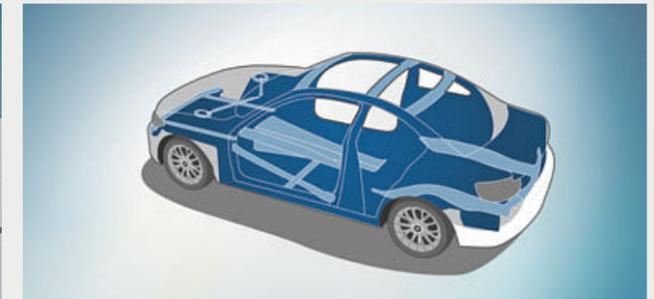
■ El **habitáculo ofrece**, gracias a la estructura funcional con soportes especiales y elementos de unión, así como al uso puntual de materiales de elevada resistencia, una seguridad pasiva óptima en caso de impacto frontal, lateral o por alcance.
