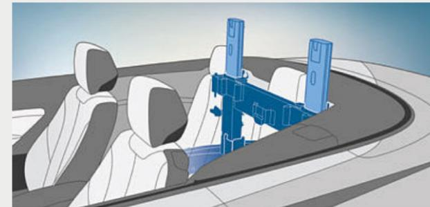
■ El **sistema de protección antivuelco<sup>1</sup>** de los reposacabezas traseros define, junto con los arcos antivuelco integrados en el marco del parabrisas, la "célula de los ocupantes". En caso de accidente, los arcos antivuelco integrados en los reposabrazos se despliegan en una fracción de segundo y mejoran la protección de la cabeza en caso de vuelco, aumentando así la seguridad.
