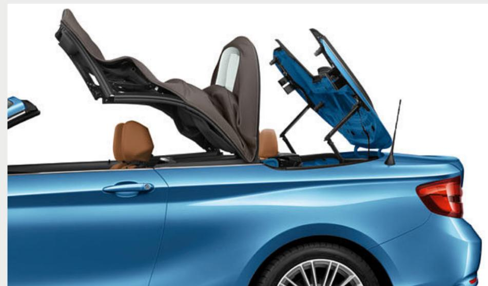
■ La capota reduce considerablemente el ruido en el interior y aísla del frío. Además, destaca por su exclusividad tanto si se observa desde el interior como desde el exterior. La capota eléctrica puede abrirse y cerrarse de modo completamente automático durante el viaje a velocidades de hasta 50 km/h.
