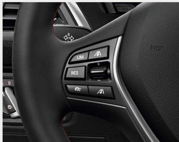
□ El control de crucero activo con función Stop&Go<sup>1</sup> mantiene la velocidad programada y la distancia con el vehículo que circula delante.
