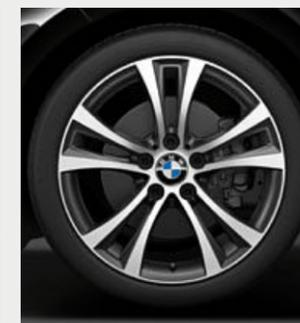
□ Llantas de aleación ligera de 18 pulgadas de radios dobles estilo 384, con neumáticos de distintas medidas, delante 7,5J x 18, neumáticos 225/40 R 18, detrás 8J x 18, neumáticos 245/35 R 18.
