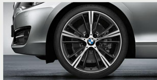
○ Llantas de aleación ligera de 19 pulgadas con radios en estrella estilo 660 en bicolor Orbitgrau, pulido brillante por el lado visible. Juego completo de ruedas RDC con neumáticos de distintas medidas, 7,5J x 19, delante 225/35 R 19 88 Y XL, y 8J x 19, detrás 245/30 R 19 89 Y XL.
