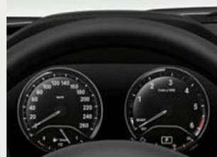
□ El cuadro de instrumentos con funciones ampliadas incluye, por ejemplo, un display de información para la presentación de indicaciones de navegación y datos de control.
