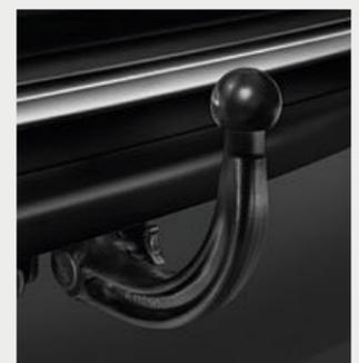
□ El enganche de remolque con bola separable permite arrastrar un remolque e incorpora un sistema de control de estabilidad del remolque.<sup>3</sup>
