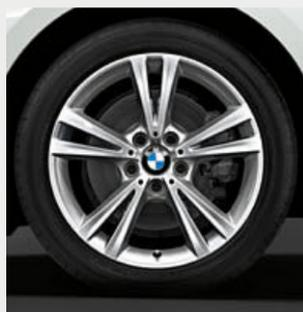
□ Llantas de aleación ligera de 18 pulgadas de radios dobles estilo 385, con neumáticos de distintas medidas, delante 7,5J x 18, neumáticos 225/40 R 18, detrás 8J x 18, neumáticos 245/35 R 18.
