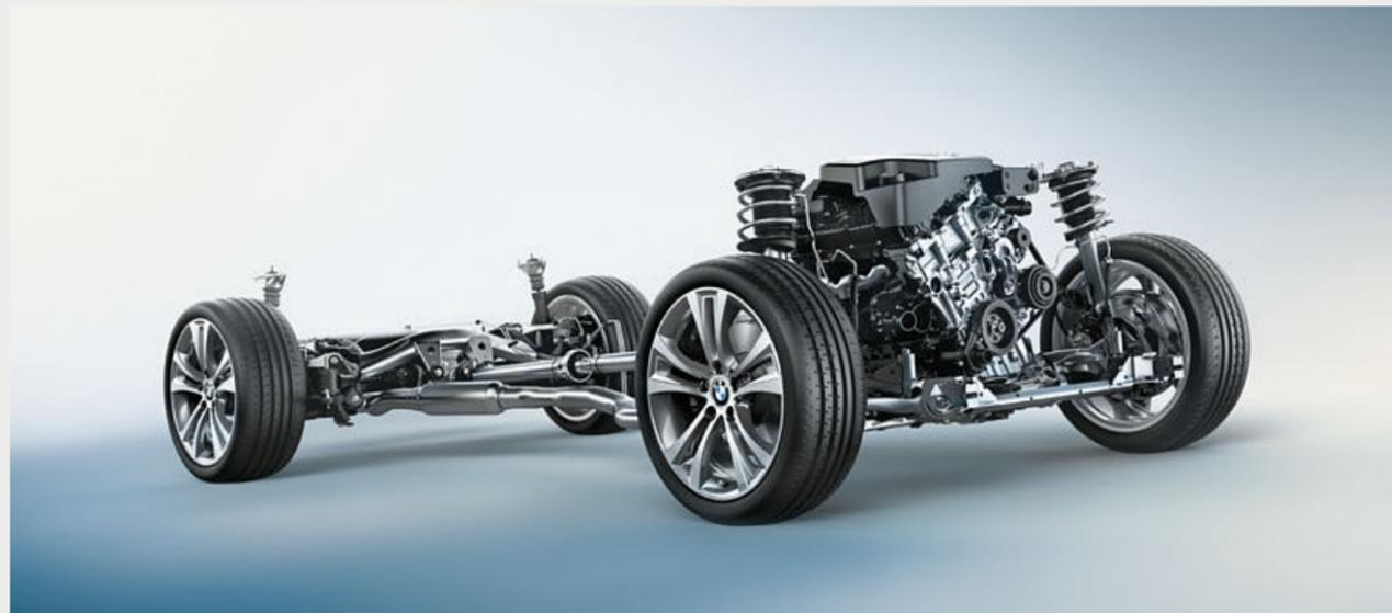
La **tracción trasera** es la base para la precisión de la dirección típica de BMW, la agilidad y la conducción deportiva. Permite una dirección sensible que no se ve influenciada por la tracción, así como el reparto ideal del peso en la proporción 50:50. Además, garantiza una excelente tracción y una gran estabilidad en las curvas.
