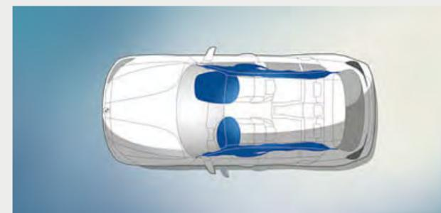
■ Los **airbags** para conductor y acompañante forman parte de los componentes de seguridad óptimamente coordinados entre sí de un BMW. Un total de seis airbags ofrecen protección selectiva: airbags para el conductor y el acompañante, airbags de cabeza para toda la superficie de las ventanillas laterales y airbags laterales en los respaldos de los asientos delanteros.
