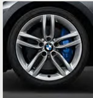
□ Llantas de aleación ligera M de 18 pulgadas con radios dobles estilo 461 M, Ferrigrau metalizado, delante 7,5J x 18, neumáticos 225/40 R 18, detrás 8J x 18, neumáticos 245/35 R 18.
