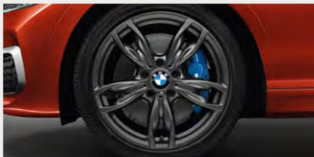
□ Llantas de aleación ligera M de 18 pulgadas de radios dobles estilo 436 M, en Orbitgrau metalizado, con neumáticos de distintas medidas, delante 7,5J x 18, neumáticos 225/40 R 18, detrás 8J x 18, neumáticos 245/35 R 18.<sup>3</sup>
