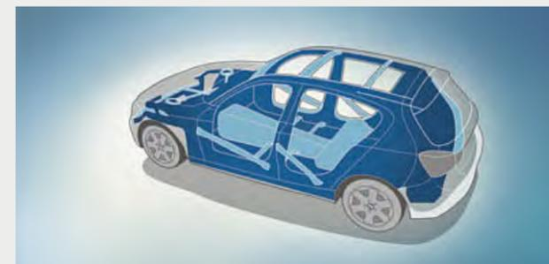
■ El **habitáculo ofrece**, gracias a la estructura funcional con soportes especiales y elementos de unión, así como al uso puntual de materiales de elevada resistencia, una seguridad pasiva óptima en caso de impacto frontal, lateral o por alcance.
