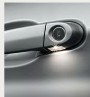
□ El acceso confort ofrece acceso al vehículo por las puertas delanteras y el portón trasero, sin necesidad de utilizar la llave del vehículo.
