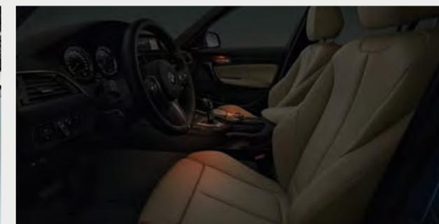
□ El paquete de iluminación crea un ambiente exclusivo en el interior. Incluye numerosos puntos de luz LED adicionales: luces de lectura delante y detrás, iluminación en los espejos de cortesía para conductor y acompañante, iluminación en la zona de los pies delante y detrás, iluminación de los embellecedores de los tiradores de las puertas, luces de estribas en las puertas e iluminación de acceso desde las manillas exteriores de las puertas.
