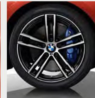
□ Llantas de aleación ligera M de 18 pulgadas con radios dobles estilo 719 M, en bicolor Jetblack, con neumáticos de distintas medidas, delante 7,5J x 18, neumáticos 225/40 R 18, detrás 8J x 18, neumáticos 245/35 R 18.
