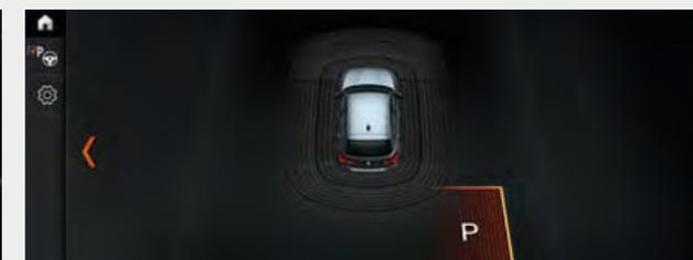
□ Park Assistant facilita el aparcamiento paralelo y transversal a la calzada. Para ello, el sistema mide las plazas de aparcamiento al pasar por delante a baja velocidad. Si encuentra una lo bastante amplia, asume el movimiento del volante y el conductor solo tiene que seleccionar la marcha, acelerar y frenar.
