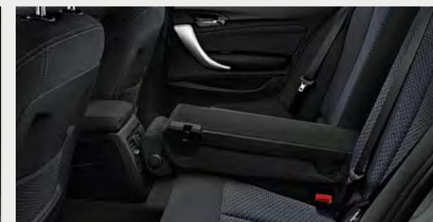
□ El sistema de carga de objetos largos incluye el respaldo del asiento trasero divisible en una proporción 40:20:40 para una mayor flexibilidad. Así, por ejemplo, en la parte trasera se pueden acomodar dos ocupantes al tiempo que se transportan objetos largos como esquís o tablas de snowboard. El reposabrazos central incluye dos portabebidas.
