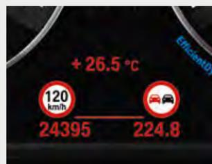
□ El Speed Limit Info<sup>2</sup> con indicación de prohibición de adelantar informa de los límites de velocidad y las prohibiciones de adelantamiento, y los muestra en el display de información del cuadro de instrumentos.
