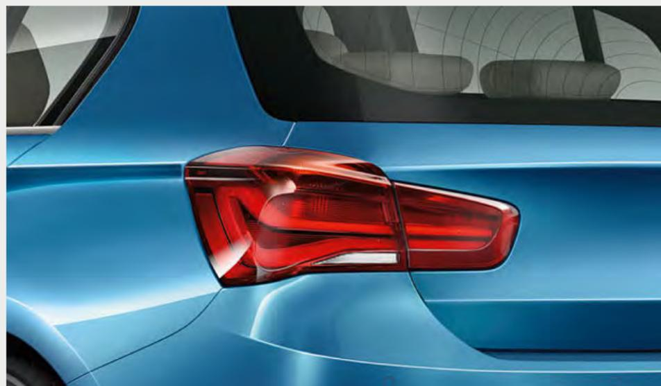
■ Las luces traseras de dos secciones con el típico diseño en L cuentan con tecnología LED. Tienen un dispositivo de alumbrado en la parte de la carrocería y en la del portón trasero. La función de luz de freno dinámica con luz de freno intermitente advierte claramente a los conductores de los vehículos que circulan detrás en caso de frenada repentina.
