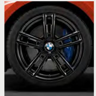
■ Llantas de aleación ligera M de 18 pulgadas con radios dobles estilo 719 M, en Jetblack, con neumáticos de distintas medidas, delante 7,5J x 18, neumáticos 225/40 R 18, detrás 8J x 18, neumáticos 245/35 R 18.
