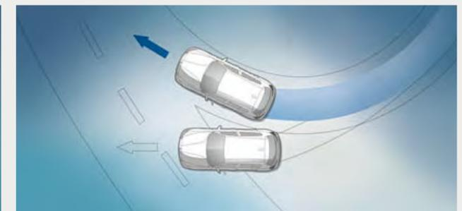
■ El **Control Dinámico de Estabilidad (DSC)** con funciones ampliadas estabiliza el vehículo en cuanto identifica una tendencia al derrapaje. Las funciones ampliadas incluyen el Control de Frenado en Curva (CBC), el asistente de arranque y al freno, el secado de frenos y la preparación de estos. Para una conducción aún más deportiva, la subfunción Control Dinámico de Tracción (DTC) permite un mayor deslizamiento de las ruedas.
