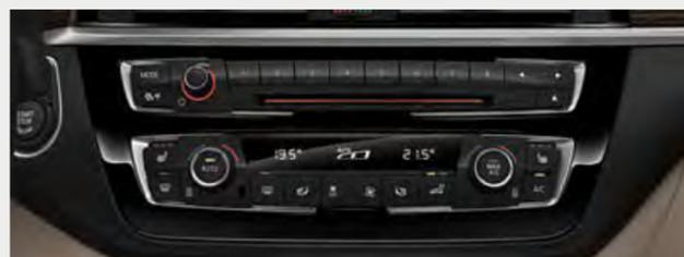
□ El climatizador bizona incluye Control Automático de Recirculación de Aire (AUC) con filtro de carbón activo, sensor solar y sensor de empañamiento.
