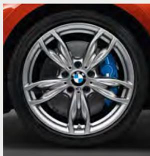
■ Llantas de aleación ligera M de 18 pulgadas de radios dobles estilo 436 M, con neumáticos de distintas medidas, delante 7,5J x 18, neumáticos 225/40 R 18, detrás 8J x 18, neumáticos 245/35 R 18.<sup>2</sup>
