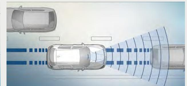
□ **Driving Assistant** combina el aviso de salida de trayecto y el aviso de colisión. Los avisos de colisión y de peatones con función de frenado en ciudad advierten<sup>4</sup>, a velocidades de entre 10 y 60 km/h, de posibles colisiones con vehículos o peatones y frenan en caso de emergencia. A partir de unos 70 km/h, el aviso de salida de trayecto advierte del abandono involuntario del carril con una ligera vibración del volante.
