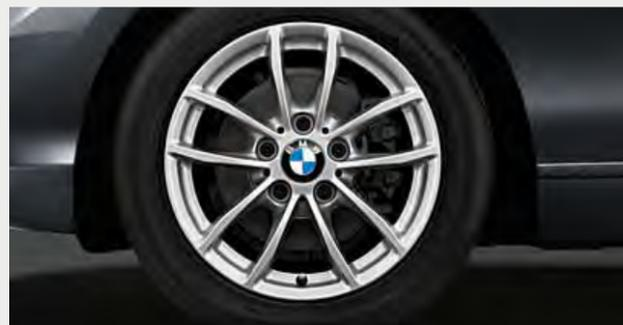
■ Llantas de aleación ligera de 16 pulgadas con radios en V estilo 378, 7J x 16, neumáticos 205/55 R 16.
