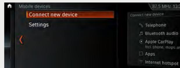
□ El equipamiento incluye un Punto de Acceso WiFi<sup>7</sup> integrado con estándar LTE, que permite conexión a Internet de pago. La conexión se lleva a cabo mediante la tarjeta SIM integrada en el vehículo y la correspondiente tarifa de pago de Deutschen Telekom AG.
