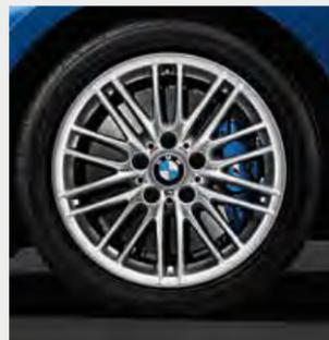
□ Llantas de aleación ligera M de 17 pulgadas de radios dobles estilo 460 M, con neumáticos de distintas medidas, delante 7,5 J x 17, neumáticos 225/45 R 17, detrás 8 J x 17, neumáticos 245/40 R 17.<sup>1</sup>
