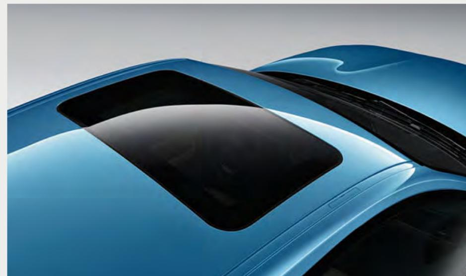
□ El techo de cristal eléctrico corredizo y abatible, con protección solar, protección antiaprisionamiento, apertura y cierre de confort con mando a distancia y mediante botones, da mucha claridad al interior y permite la regulación individual del flujo de aire y, por lo tanto, un clima agradable en el interior. El deflector de viento integrado que se despliega automáticamente garantiza un elevado confort acústico.
