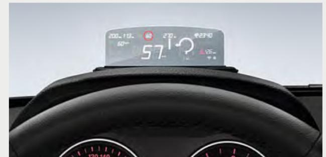
○ En combinación con una interfaz de smartphone, el BMW Head-Up Display proyecta información del vehículo y de la navegación en el campo de visión del conductor.
